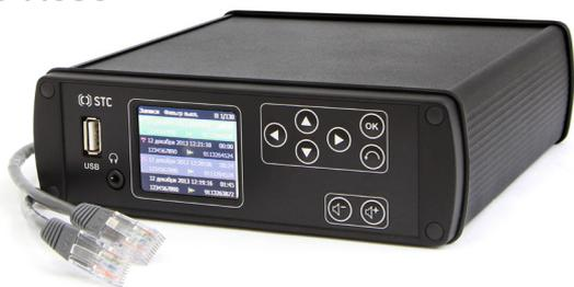
Цветной 2-х дюймовый ЖК-дисплей с интерфейсом ручного управления и разъемом для подключения наушников
