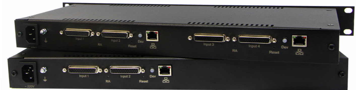
Устройство Smart Logger BOX STC-H730 и STC-H732 в конструктиве для монтажа в стойку 19"
