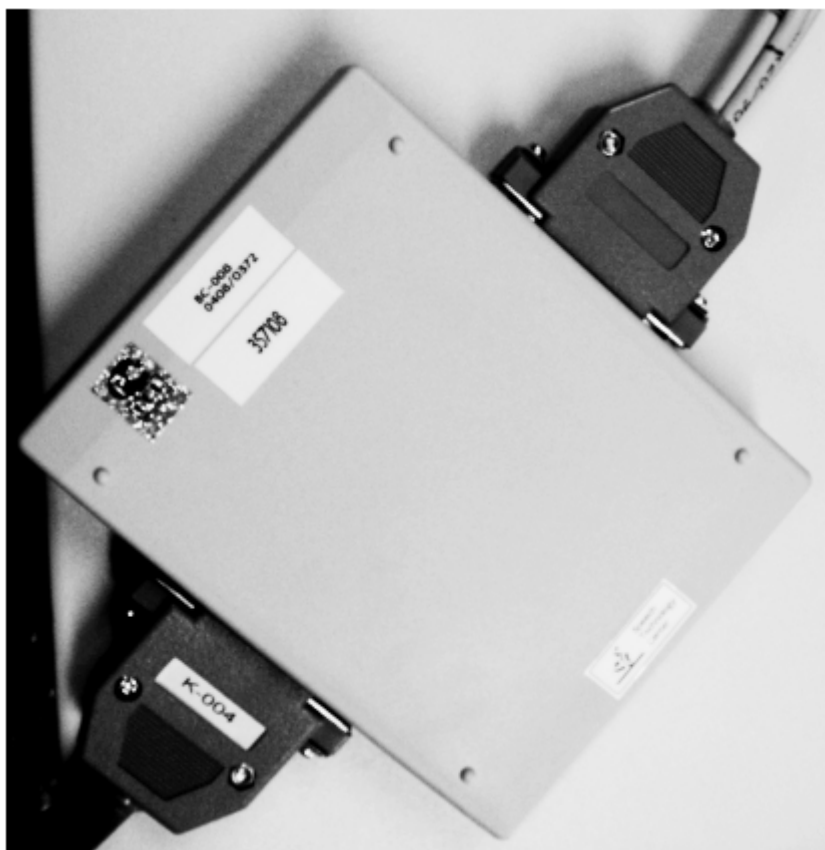
Рисунок 7 – Подключение кабелей к блоку БК-008
