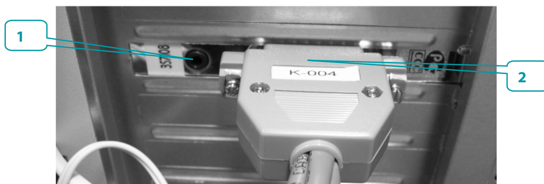
Рисунок 6 – Подключение кабеля К-004 к плате ввода\вывода
