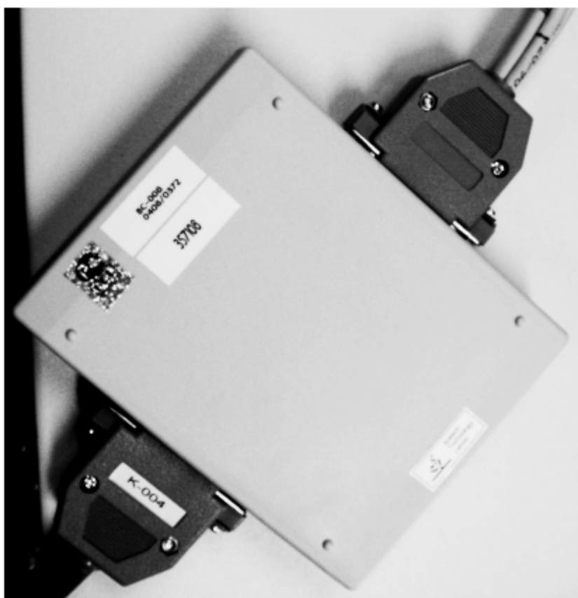
Рисунок 7 – Подключение кабелей к блоку БК-008
