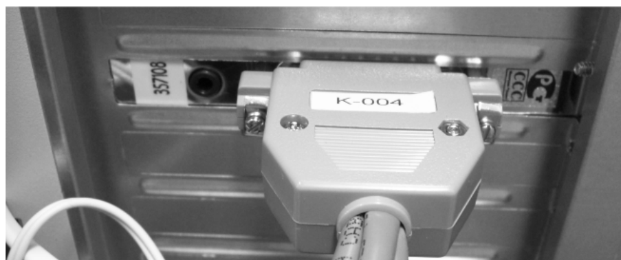
Рисунок 6 – Подключение кабеля К-004 к плате ввода\вывода
