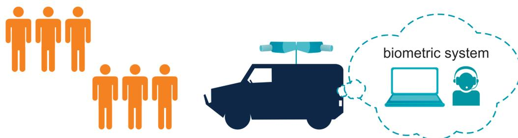
Мобильный комплекс устанавливается внутри фургона, а камера с сильным оптическим зумом – в специальном защитном кожухе на крыше автомобиля. Служебный фургон может перемещаться в местах повышенного скопления людей: в районе проведения митингов, демонстраций, а также во время организованных протестов и беспорядков.
