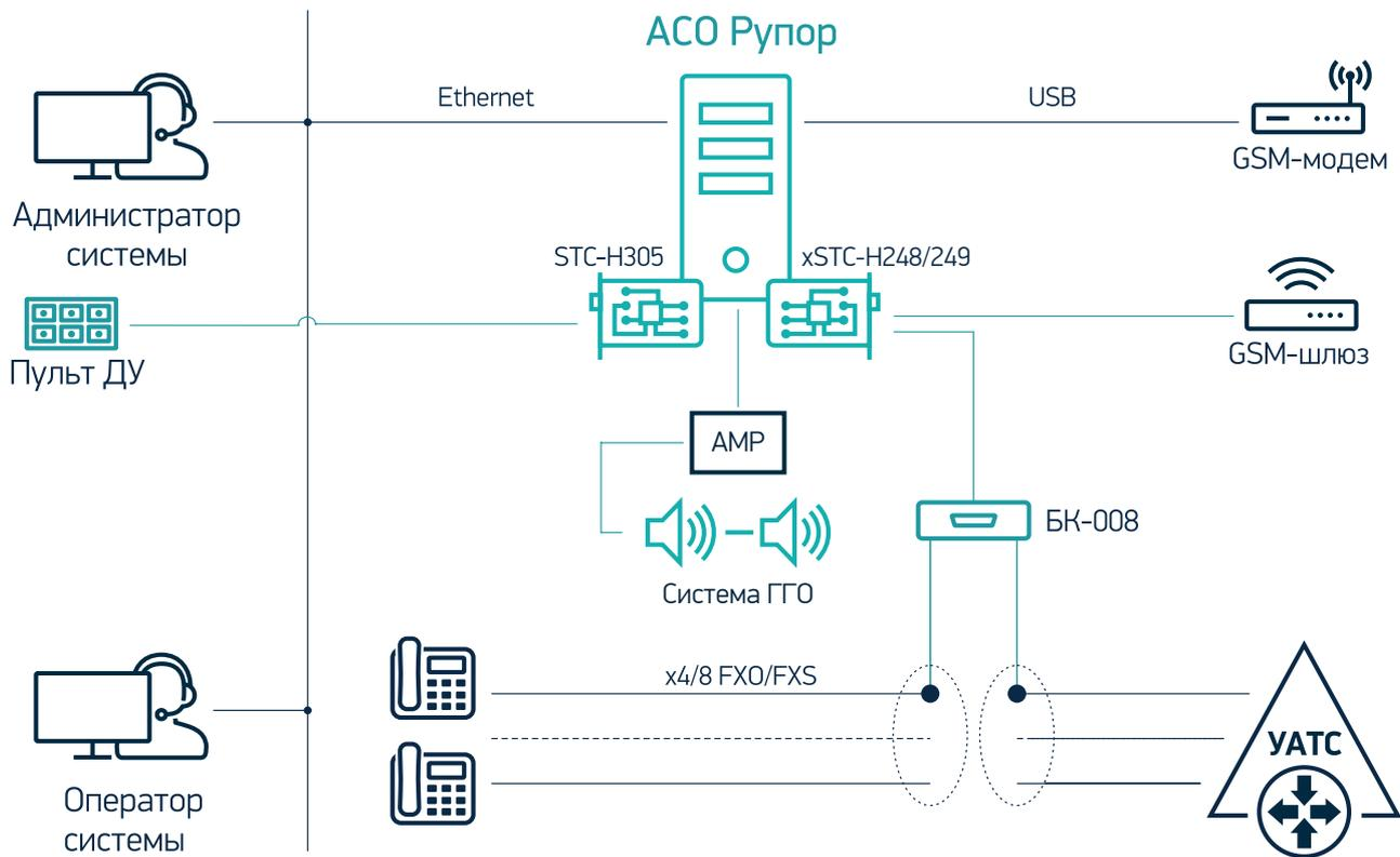
Схема развертывания системы оповещения Рупор
