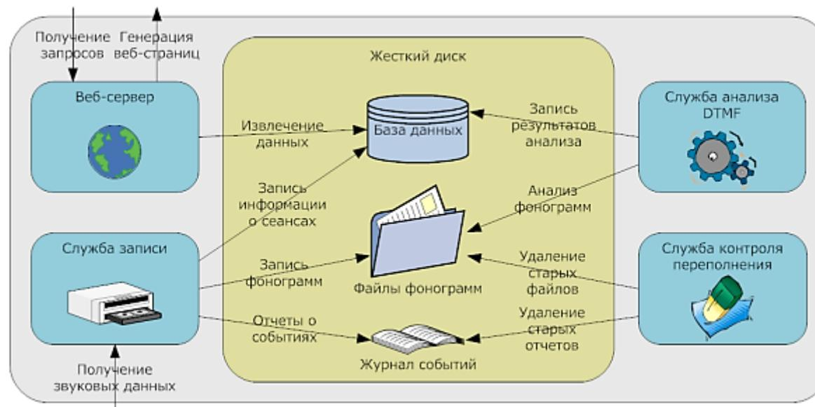
Рисунок 2 – Компоненты встроенной программы управления устройством
