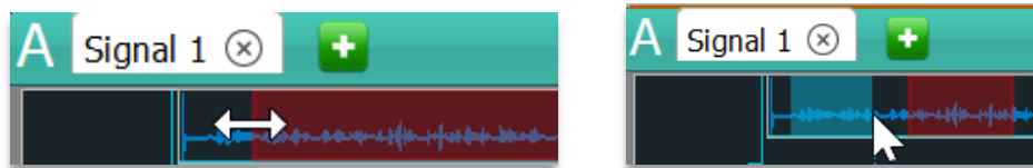
Рисунок 51 – Изменение размера (слева) и выбор области данных (справа) на навигационной осциллограмме
