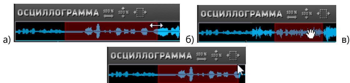
Рисунок 26 – Изменение размера (а), перемещение подсвеченной области (б) и выбор (в) области данных, видимых в окне, на навигационной осциллограмме
