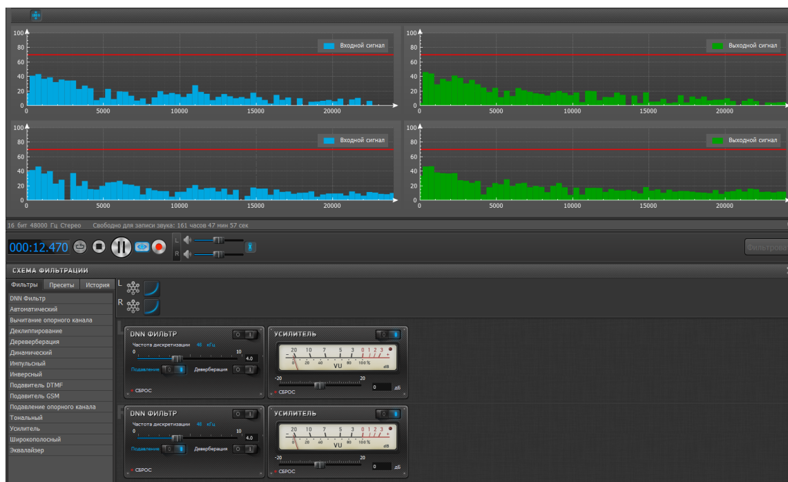
Рисунок 88 – Графики спектров входного (слева) и выходного (справа) сигналов для стереосигнала
