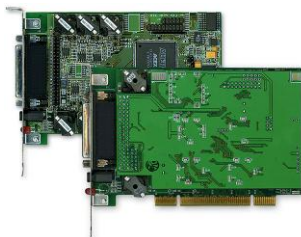
Интерфейсная плата STC-H199 с мезонином STC-H207.
