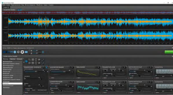
Осциллограмма и схема обработки стереосигнала с заданными экспертом последовательностью фильтров и параметрами
