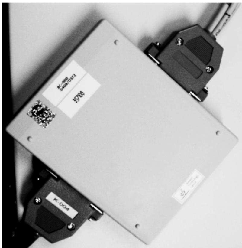
Рисунок 7 – Подключение кабелей к блоку БК-008
