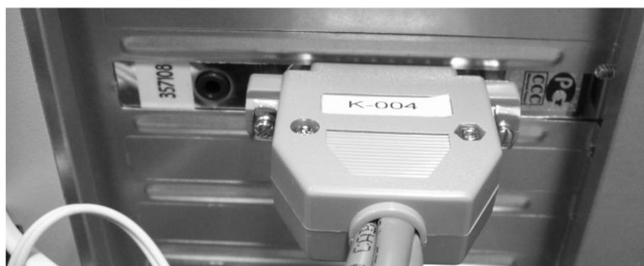
Рисунок 6 – Подключение кабеля К-004 (К-049) к плате ввода\вывода
