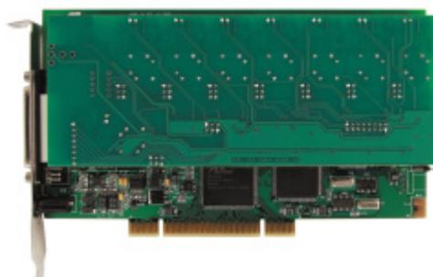
Рисунок 3 – Плата ввода\вывода звука
